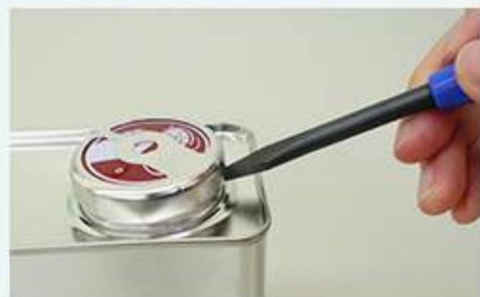
マイナスドライバーのような平たい金属棒を、プロテクターの下に差し込みます。
